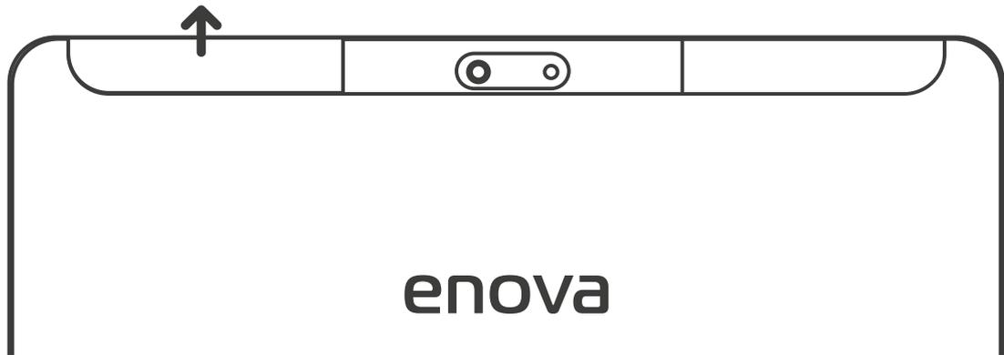
3. Inserte su/s tarjeta/s SIM como muestra en la imagen. Por favor revise detenidamente el formato de tarjeta SIM compatible con el dispositivo. Verifique correctamente el sentido de colocación de la tarjeta. Introduzca la tarjeta en el compartimiento.
