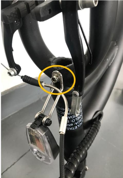
Retire el tornillo junto con la luz delantera
