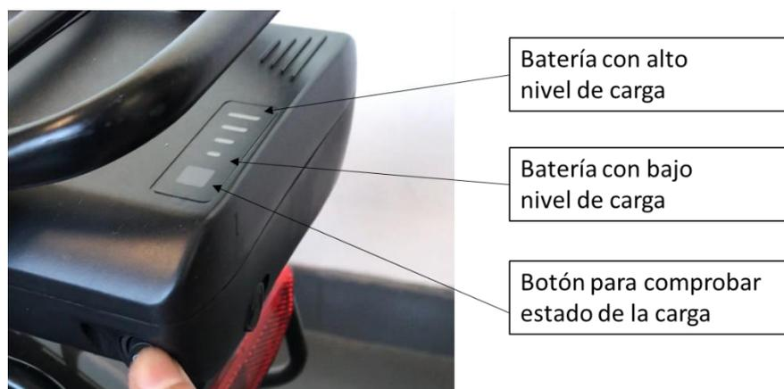
Para saber el estado el estado de carga de la batería desde el panel de control de manubrio, debe tener encendido el panel de control. Para encenderlo presione el botón ON/OFF.
