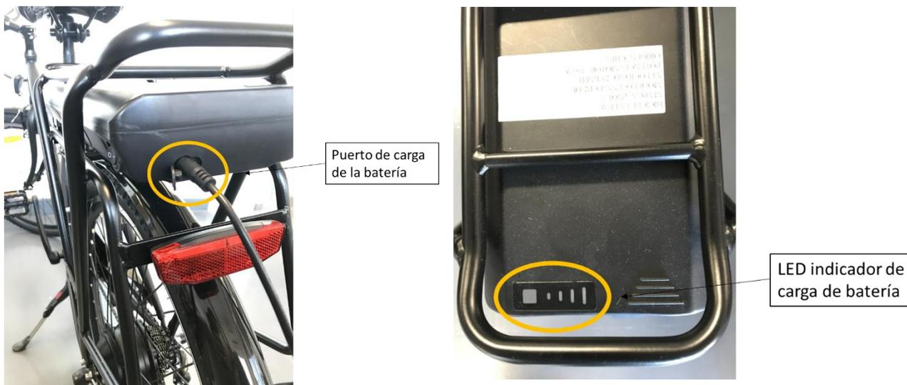
La batería viene equipada con un indicador lumínico que le muestra rápidamente el estado de carga de la batería. En el manubrio, en el panel de control, la bicicleta también posee un testigo para ver el nivel de la batería.
