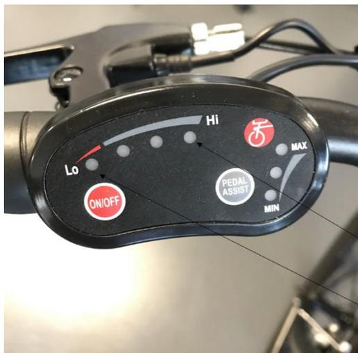
Batería con alto nivel de carga
