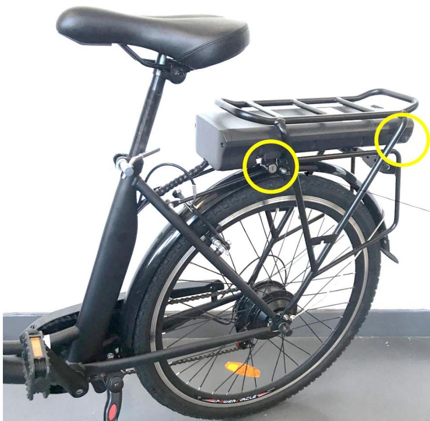
Interruptor de encendido apagado
